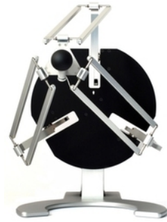
Obrázek 2.1.1: Haptické zařízení Delta.3 od firmy Force Dimension
