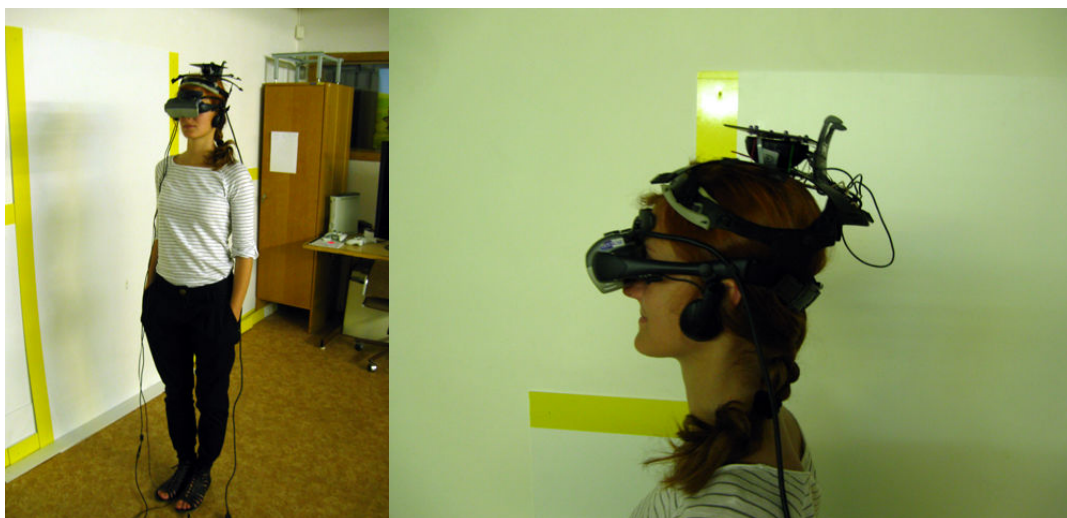
Obr. 3 Uživatel s nasazeným HMD a síťkou se snímacím zařízením a přidavným IR osvětlením
