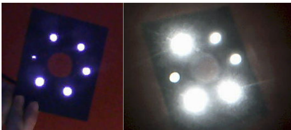
Obr. 36 Vlevo snímek infračervených LED kamerou s IR filtrem, vpravo ty samé LED ve snímku z kamery bez filtru
