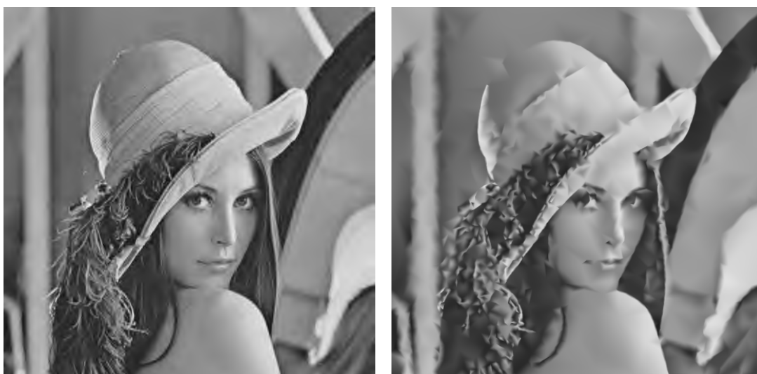
Obraz 6.3: Obraz Lena. Oba komprimované soubory mají přibližně stejnou velikost 5 kB. JPEG 2000 vlevo má PSNR 32 dB, triangulace 28 dB.
