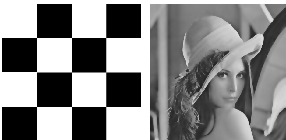
Obraz 6.7: Obrazy s ostrými hranami. Vlevo šachovnice (černo-bílá bez odstínu šedi), vpravo obraz Lena rozmazaný selektivním gaussovským filtrem o poloměru 10.
