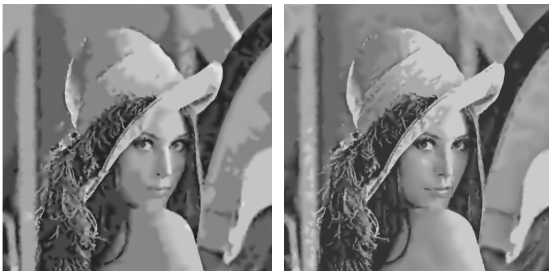
Obraz 7.4: Kvantizace na tři bity na pixel. Vlevo rovnoměrná kvantizace PSNR 26,3 dB, vpravo Median cut metoda PSNR 28,6 dB.
