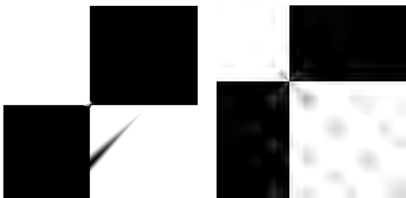
Obraz 6.8: Komprese šachovnice. Vlevo triangulace s PSNR 31 dB, SSIM 0,99; vpravo JPEG 2000 s PSNR 32 dB a SSIM 0,81.
