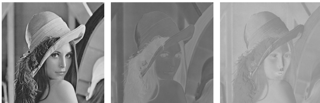
Obraz 2.3: Jednotlivé kanály modelu YCbCr. Zleva Y , Cb a Cr .
