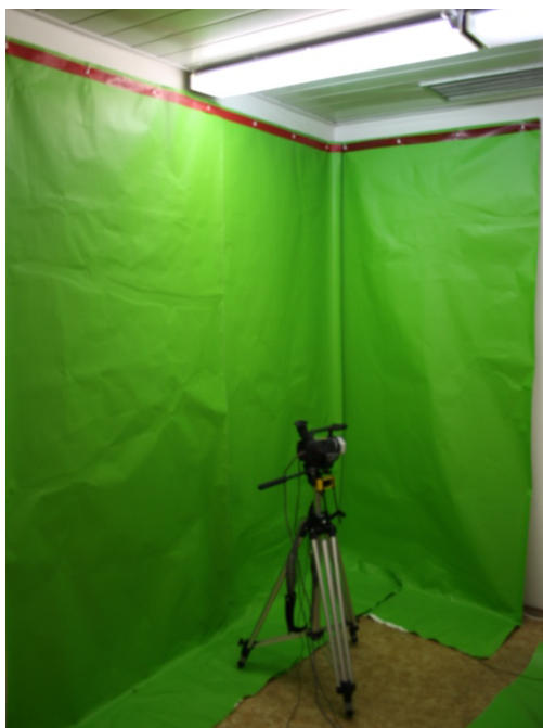
Obr. 6.1 Klíčovací pozadí z PVC folie použité v našem systému.
