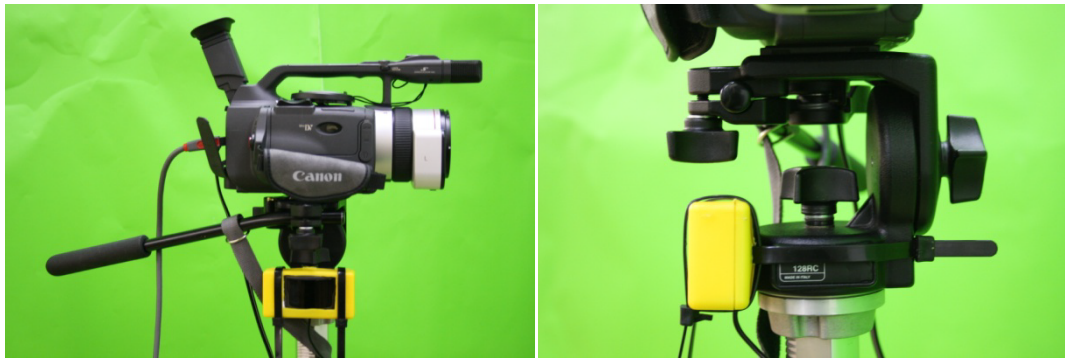
Obr. 6.3 Kamera Canon XM2 s připevněným trasovacím zařízením (žlutá krabička)
