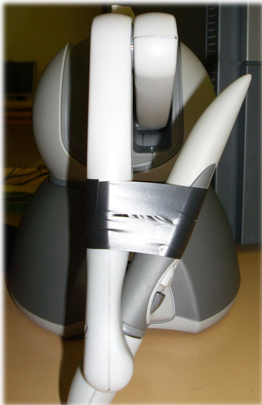
Obrázek 9: Zafixování pera zařízení Phantom Omni
