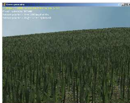
Obr. 3.16: Zde je již využitý náhodný posun každého trsu a trávník se tím jak vidno stává daleko vizuálně přitažlivější. Již není například na první pohled vůbec patrné, že je tráva tvořena jedním trsem.
