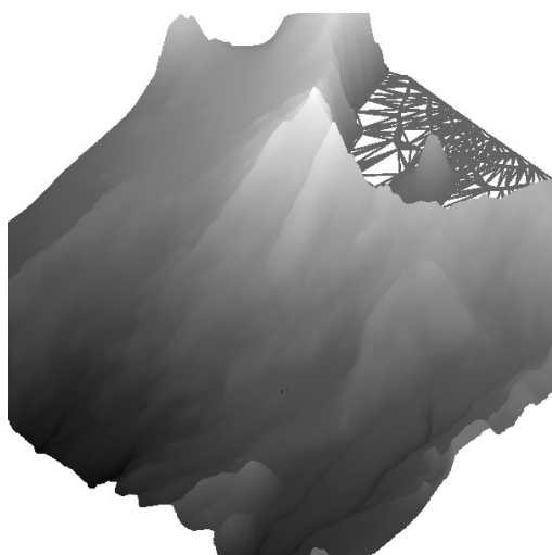
Obrázek 2.2.1: Vepředu velmi členitá trojúhelníková síť; v zadní části (na rovině) je členitost menší (pohled z boku)
