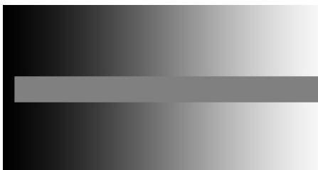
Obr. 2.3 Jednoduchý optický klam ukazuje vliv okolní plochy. Střední pruh je v celé své délce stejně šedý, přesto může být vnímán jako přechod od světle šedé (vlevo) po tmavší šedou (vpravo) [16].
