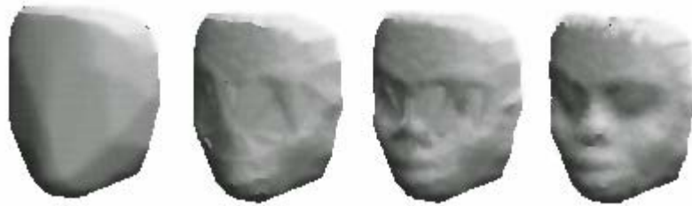
Obr. 3-12 : Průběh algoritmu „ \gamma -indikátor“ (zleva : konvexní obálka, dvě mezifáze algoritmu, výsledný povrch).
