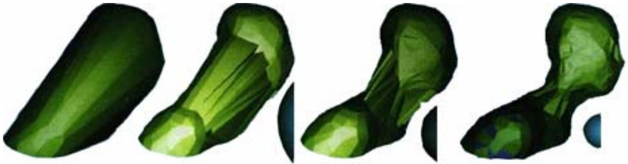
Obr. 3-6 : Kroky algoritmu „ \alpha -shape“ v 2D. (zleva –Delaunayova tetrahedronizace vstupní množiny bodů, dále ukázka vlivu velikosti parametru \alpha na rekonstrukci pomocí koule znázorňující velikost parametru \alpha (část koule vždy napravo od obrázku).
