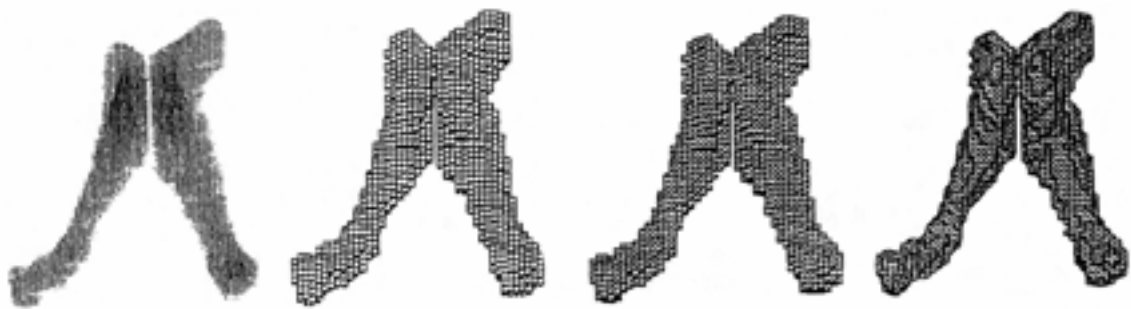
Obr. 3-1 : Kroky algoritmu (zleva – množina vstupních bodů, extrahované voxely, první aproximace povrchu, výsledná trojúhelníková síť).
