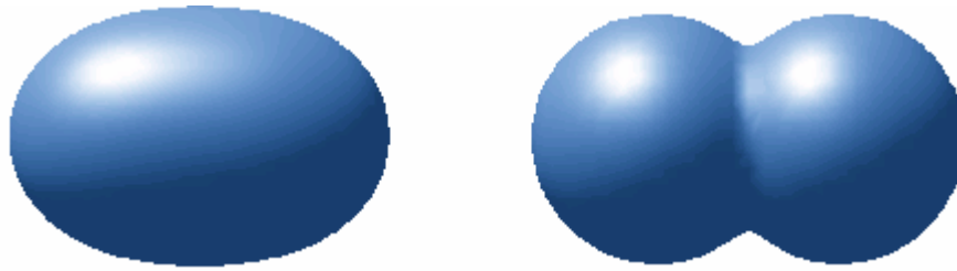
Obr. 3-16 : Příklad vlivu funkcí. „Soft“ funkce vlevo spojuje dvě koule dohromady, „sharp“ funkce vpravo naopak zachová detaily.
