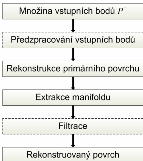
Obr. 2-2 Diagram rekonstrukce povrchu využívající Delaunayovu tetrahedronizaci
