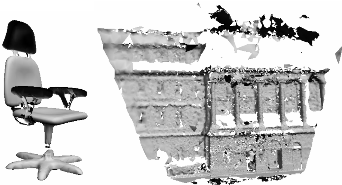
Obr. 2-1 Ukázka špatně rekonstruovaných objektů metodou CRUST. Rekonstrukce neproběhla správně, protože objekty nesplňují vzorkovací kritérium.
