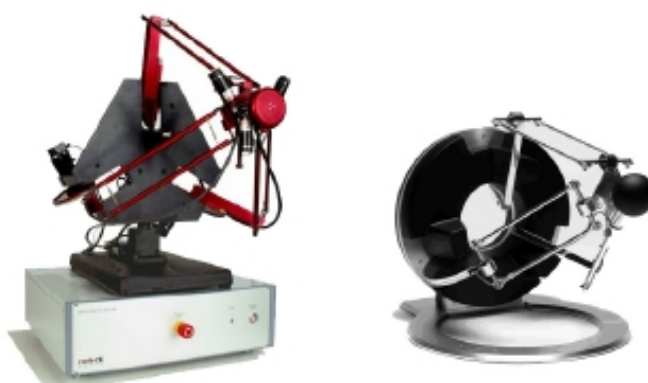
Obr. 2.5: Haptická zařízení 6DOF Phantom (vlevo) a 3DOFOmega (převzato z [BEN06])
