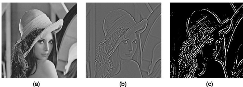
Obr. 5.3.: (a) vstupní obraz, (b) po konvoluci s Laplaciánem, (c) prahování výstupu
