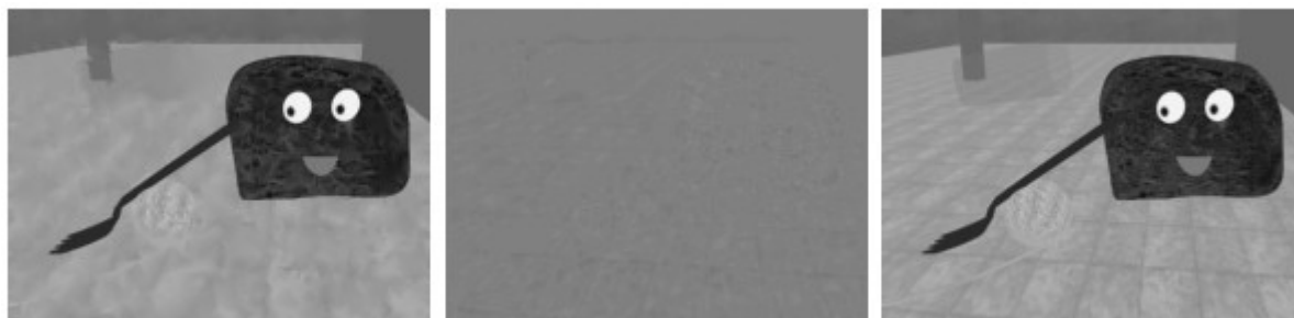
Obr. 9.5: Zleva: aproximace vložením 20% bodů, residuum, originální snímek
