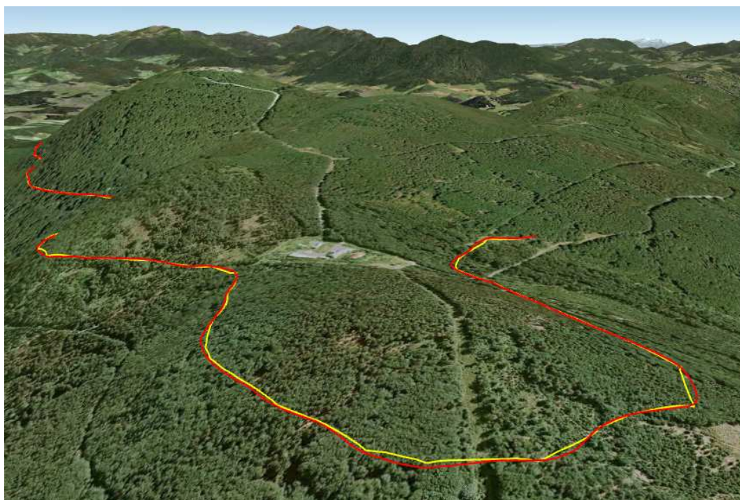
Obrázek A.3: Porovnání vlivu bilineární (žlutá) a bikubické (červená) interpolace DMR na průběh nalezené trasy.
