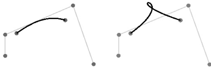
Obr. 5.1: Tvary Bézierovy křivky při různých hodnotách parametru b (vlevo b = 0,2 ; vpravo b = 0,8 )
