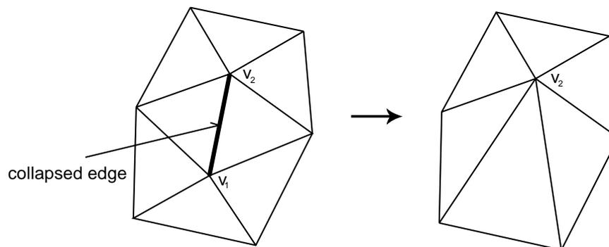
**Figure 14: Edge collapse operation**
